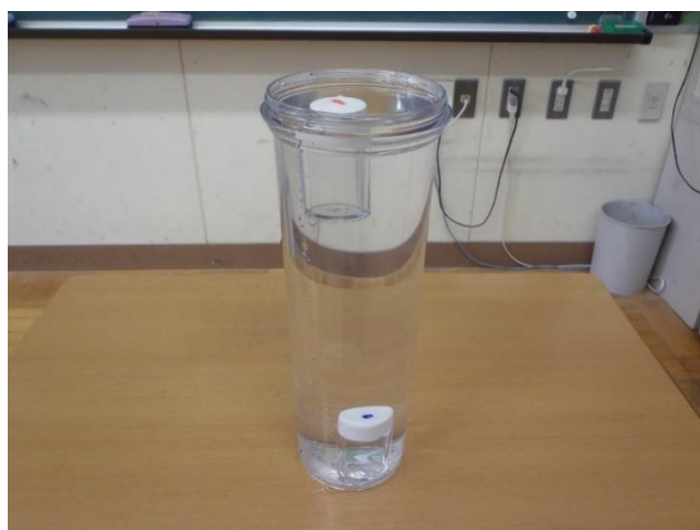
温かい水は上方に、冷たい水は下方に移動した様子
